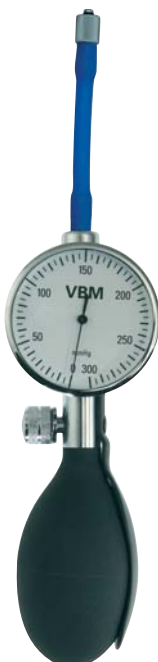
Manomètre 300mmHg avec poire pour pompage manuel, valve d'échappement et connexion Luer Lock mâle REF 51-09-666
