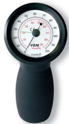
VARIABEL Ø 50mm Skala mit verstellbarem Zeiger (Skala in cmH 2 O und mmHg) Silikon-Endotrachealtuben haben eine schnellere Diffusion der Narkosegase. Der notwendige minimale Cuffdruck wird mittels verstellbarem Zeiger markiert. Druckanstiege werden mit dem Ablassventil auf den markierten Wert abgelassen. REF 54-06-000
